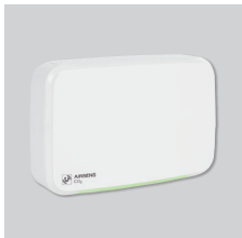
AIRSENS SABIK-CO2 NL Luchtkwaliteit-sensor voor vraag-gestuurd ventileren. 230V voeding, bedrade communicatie. Tot 4 sensoren op 1 SABIK-unit.
